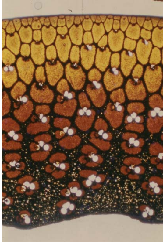
Bild 9: Querschnitt durch die Wand eines Bambusrohres Lange Bildkante 6,13 mm
